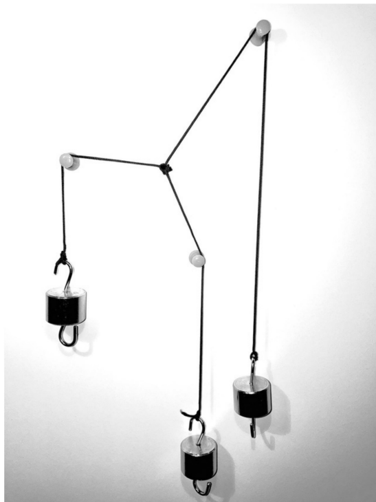
Obr. 3: Řešení pomocí závaží a kladek
