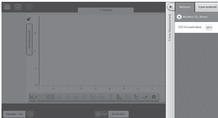
Obrázok 2.39: Výber konkrétnej hodnoty na meranie, počet v ponuke závisí od typu senzora
