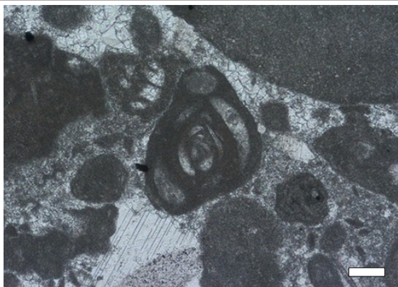
Obr. 125. Priechny, mierne šikmý prierez miliolidným dierkavcom Quinqueloculina robusta Neagu. Jedná sa o formu s miliolidným typom vinutia. Formy s miliolidným usporiadaním komôrok sa objavujú už počas strednej jury, hojne sa však začínajú vyskytovať až počas spodnej kriedy v plytkovodných platformových karbonátoch tzv. urgónskeho typu (výbrus: 1344, vek: vrchný barém – spodný apt, lokalita: Mošurov, Ľubovnianska vrchovina, Slovensko, mierka: 100 \mu m).
