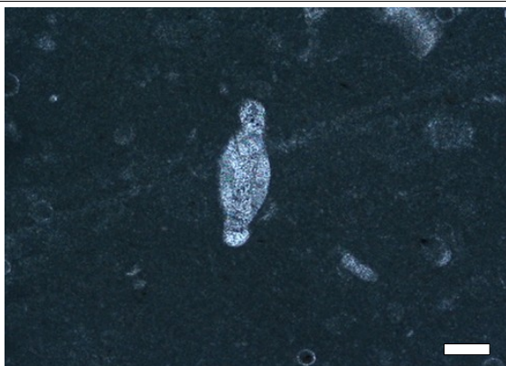
Obr. 159. V strede mikrosnímky sa nachádza pozdĺžny prierez dierkavcom druhu Radiospirillina umbonata Blau & Wernli. Mikrosnímka je nasnímaná v polarizovanom svetle, pri rovnobežných nikoloch. Deuterolokulus je rozsvietený. Hyalínne časti schránky, tvoriace výplne umbilikálnych oblastí zhášajú v závislosti od orientácie kryštálov. Okolie dierkavca tvorí mikritová základná hmota a početné drobné prierezy kalpionelami (výbrus: 19765, vek: vrchný titón, lokalita: Vršatec, Biele Karpaty, Slovensko, mierka: 100 µm).
