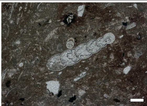
Obr. 174. Pozdĺžny prierez nodosaridným dierkavcom s uniseriálnym usporiadaním komôrok. Z prierezu je možné zistiť počet a tvar komôrok, celkový tvar schránky, septá a ich priebeh, hĺbku a charakter sediel. Veľkosť prvej komôrky (prolokula) naznačuje, že sa jedná o megalosférického jedinca, nakoľko je väčšia ako deuterolokulus (výbrus: 17167, vek: vrchný bajok-kelovej, lokalita: Beňatina, Vihorlatské vrchy, Slovensko, mierka: 100 \mu\text{m} ).
