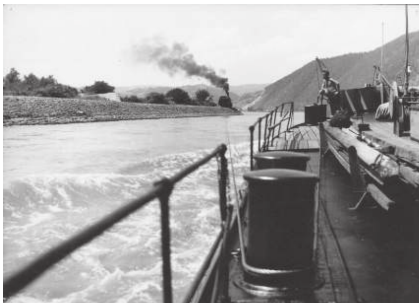
Obr. č. 7: Špeciálny vlečný rušeň ťahom lana z brehu pomáhal vlečným konvojom prekonať extrémne silný prúd vody v Sipskom kanáli. Zdroj: STM-Múzeum dopravy v Bratislave
